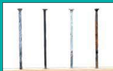
Próbki gwoździ po 168 godzinach (7 cykli) w komorze wilgotnościowej
